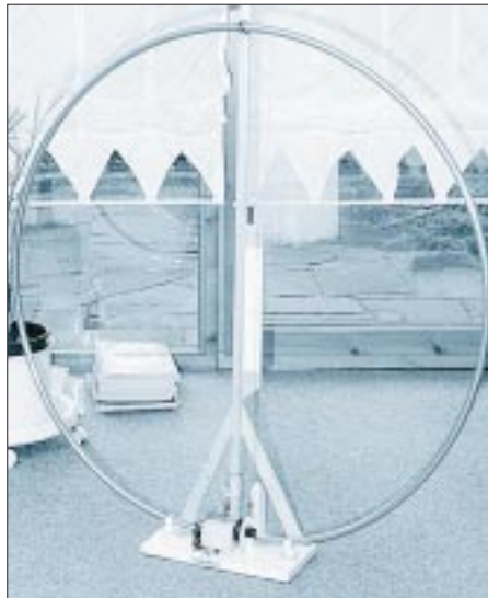
Bild 7: Die Antenne mit einem Besenstiel als „Mast“ und einer Schnurskale
