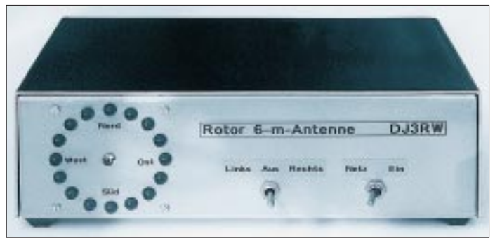
Bild 5: Das fertige Bedienteil zur Steuerung eines selbstgebauten Rotors
