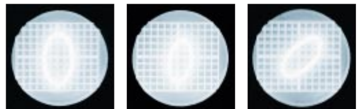
Bild 14: Oszillogramme, die die Pasenverschiebung zeigen. Links – 90°, o.k.; Mitte – Frequenzbereich überschritten; rechts – totale Fehlfunktion Fotos: Autor
