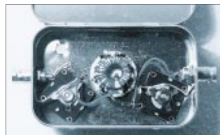
Bild 3: Ansicht des fertiggestellten p-Filters in einer Apothekenschachtel. Die Beschriftung erfolgte per Laserdrucker und selbstklebendem Ordner-Label. Fotos: DL2LUX
