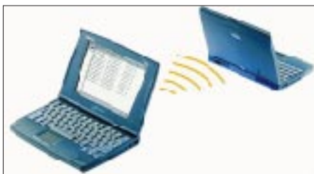
Bild 2: Der Datenaustausch zwischen den Rechnersystemen ist auch per Infrarotverbindung möglich.
