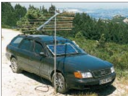
IWO/DG0ZB/p, auf dem Monte Limbara (JN400U) in 1300 m Höhe ü. NN. Mit ein paar Watt (aus Sonnenkollektoren) an einer 12-Ele.-M 2 gelangen Knut am 5.6. Verbindungen bis 912 km (ODX in JN28).
