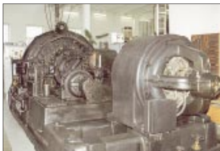
Der Maschinensender für Längstwelle besteht aus Motor (rechts), Getriebe (Mitte) und Generator (links).
