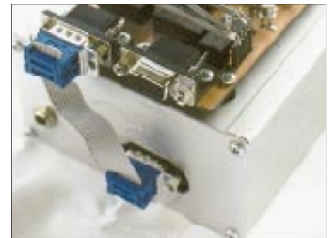
Bild 7: Das DSP-Kit ist in ein Aluminiumgehäuse eingebaut. Die Ladung der Software erfolgt über Brücken-Flachkabel. Der PC wird an die zweite Schnittstelle meiner Baugruppe angeschlossen. In Schalterstellung 0 des Programmwahlschalters wird das serielle Schnittstelle durchgeschleift. Links die Buchse der 12-V-Stromversorgung. Fotos: DL4JAL
